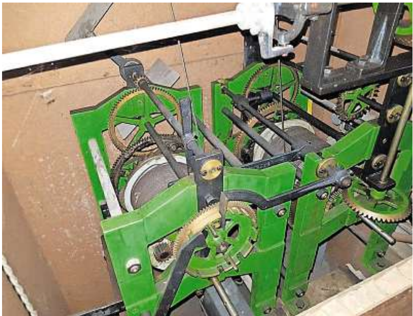
In gutem Zustand: links das Läutwerk, rechts die Uhrmechanik.
